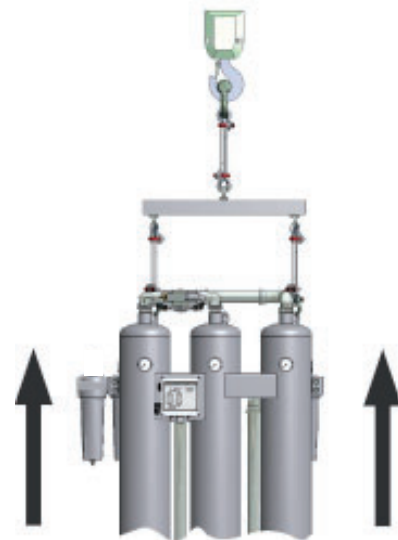
II: Colocación con grúa
